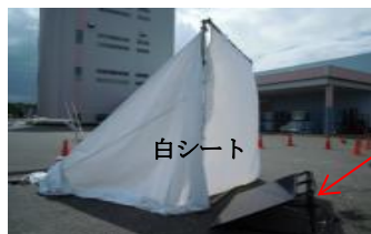
図-1: 白シート遮蔽の様子 (直射日光のみを遮蔽)
