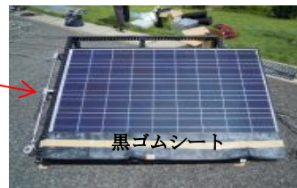
図-2: 黒ゴムシート遮蔽の様子 (全日射を遮蔽)
